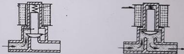
SI. 5.6. Princip rada elektromagnetskog ventila - a. ventil zatvoren za protok vode, b. ventil otvoren za protok vode
